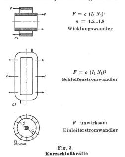
Eine Ausnahmestellung nimmt der Einleiterstromwandler (Fall c) ein. Wie aus einer einfachen Ueberlegung zu ersehen ist, würde jede «virtuelle Verschiebung» des Primärleiters seine Zentrierung zur Folge haben und den ursprünglichen Abstand  $r_2$  wieder herstellen. Der Einleiterstromwandler hat somit eine praktisch unbegrenzte dynamische Festigkeit.
