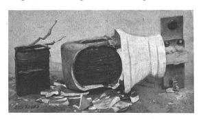
Fig. 2. Wirkung der abstossenden Sprengkraft bei ca. 320fachem Nennstrom
