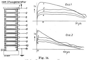
Säulen-Spannungswandler Spannungsverteilung bei Stoss 1|50
