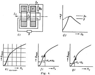
Gesteuerte Eigenvormagnetisierung und Wechselstrom-Magnetisierungskurven a, b Eisenkerne. B Bürde. BH Impedanz.
