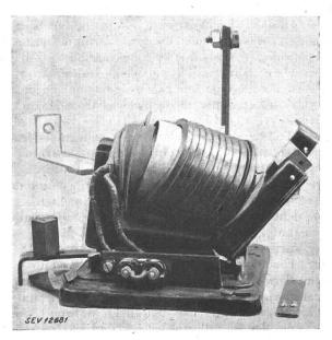
Fig. 1. Wirkungen axialer Schubkräfte bei ca. 150fachem Nennstrom
