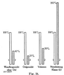
Vergleich zweier Spannungswandler der Nennisolations-spannung 150 kV der bisherigen und der neuen Ausführung
