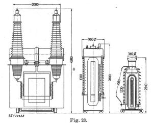
Grössenvergleich von Spannungswandlern der Nennisolationsspannung 150 kV mit verschiedenem Baujahr
