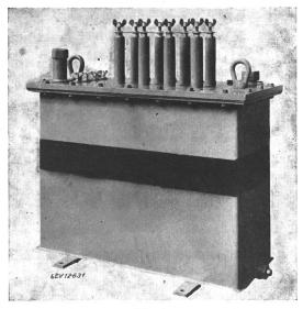
Fig. 1. Einphasen-Eich-Wandler 3 VA 16 000/8000/4000 / 25/100 V, 50 Hz Zur bequemen primärseitigen Umschaltung besitzt der Wandler 8 durch Laschen umschaltbare Oberspannungs-Durchführungen.
