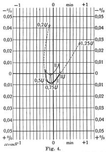
Ortskurven des Uebersetzungsfehlers und Fehlwinkels des Einphasen-Eich-Wandlers Fig. 1 3 VA 16 000/8000/4000 / 25/100 V 50 Hz I Leerlauf. II 3 VA,  $\cos \beta = 0.8$ .
