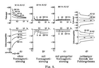
Messgenauigkeit von Stromwandlern der Nennisolationsspannung 150 kV bei 50 Hz
