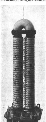
gestelle für Wandler der Nennisolationsspannung 60 und 150 kV erkennen, die nach den eingangs dargelegten Gestaltungsgrundsätzen ausgeführt sind. Ihre fast revolutionäre Schlankheit ist dadurch begründet, dass die Gestelle auch noch den elektrischen Anforderungen hinsichtlich Spannungssteuerung Vorteile bieten. Denn Fig. 21 offenbart, wie die Oberspannungswick-
