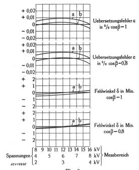
Fig. 2. Fehlergrössen des Einphasen-Eich-Wandlers Fig. 1 in Abhängigkeit der Spannung
