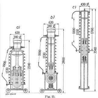
Stromwandler der Nennisolationsspannung 150 kV verschiedener Ausführungen mit Spreizflansch-Isolation
