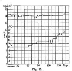
Innendruck und Raumtemperatur eines Einphasen-Druckluft-Spannungswandlers Typ TMDe der Nennisolationsspannung 30 kV im Dauerversuch
