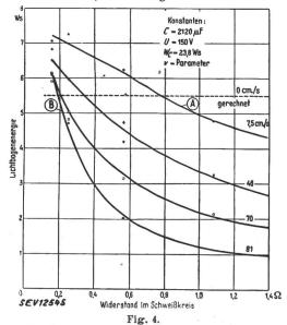
Erwärmungsenergie an der Schweißstelle in Abhängigkeit vom Widerstand des Schweisskreises
