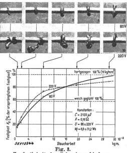
Zugfestigkeit der Schweissverbindung, abhängig von der Staucharbeit
