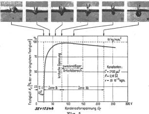
Fig. 5. Zugfestigkeit der Schweissverbindung, abhängig von der Kondensatorspannung
