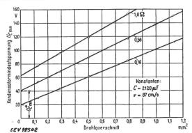
Fig. 1. Kondensatormindestspannung, abhängig vom Drahtquerschnitt
