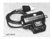
Description: Moteurs série monophasés pour machines à coudre. Le coffret en matière isolante moulée, adossé au moteur, comprend: une fiche d'appareil pour le raccordement au réseau, une prise pour l'alimentation d'une petite lampe et un condensateur antiparasite. Le moteur possède un câble blindé, fixé à demeure, muni d'une prise d'appareil pour le raccordement de la résistance de réglage à pied.
