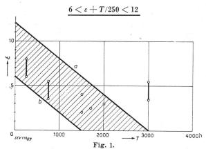
Leistungsziffer  $\varepsilon$  und Benützungsdauer T der Wärmepumpen in Zürich
