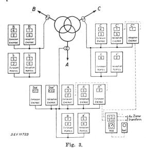
Schéma de principe complet de l'un des transformateurs Les chiffres inscrits dans les cadrans indiquent les régimes pour lesquels ces cadrans enregistrent la quantité d'énergie fournie ou reçue par le circuit correspondant.
