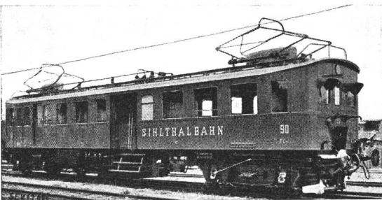
Fig. 4. Triebwagen der Sihltalbahn aus dem Jahre 1929 52 Sitzplätze, Tara 52 t Motorleistung 3×162 kW
