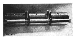
Fig. 7. Ansicht des Bandfilterverstärkers für  $\lambda =$  1,7 m
