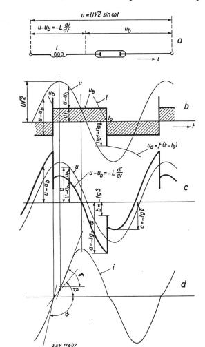
Fig. 2. Stabilisation par bobine de self-induction
