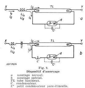
filaments des deux électrodes du tube TL reste seule en série avec la self-induction, elle est très petite; le courant est donc assez intense et les électrodes sont portées à l'incandescence. Pendant
