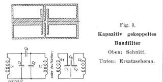
besser als bei Schwingkreisen mit Spulen und Kapazitäten für Wellen derselben Länge, für die der Schwingtopf gebaut ist), ferner mechanische Stabilität und die durch die Bauart und den Skineffekt bedingte Selbstabschirmung.
