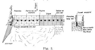
Détails de la partie droite du barrage de Pontebrolla Plan montrant la disposition des travets et des planches ajoutées pour élever le niveau amont; coupe à travers la digue: fixation des travets et des planches.
