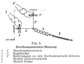
Im allgemeinen wird die Messung der Beanspruchung an einem bestimmten Punkt mit nur einem Kondensator den gewünschten Aufschluss ergeben, besonders dort, wo die den Seilzug aufnehmenden Organe (Isolatoren usw.) beweglich sind.
