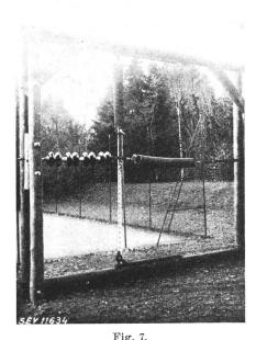
Isolatoren-Prüf-Einrichtung für dynamische Beanspruchung der Prüfobjekte Beide Zugfedern entspannt
