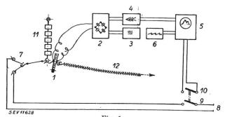
Fig. 1. Schematische Darstellung der Kräfte-Messeinrichtung (für Seilbruch-Versuch)
