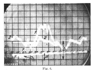
Isolatoren-Beanspruchung (am oberen Kettenende) bei Seilbruch, alle Spannweiten mit 3 kg/m belastet, bei Halbabspannung
