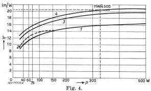
Verlauf der Lichtausbeute  $(\eta)$  in Abhängigkeit der Leistungsaufnahme (P) von verschiedenen Lampen
