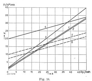
Betriebskosten (K) in Funktion des Energiepreises (k) der Kleinspannungslampe
