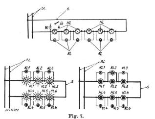
Reihenschaltung von Kleinspannungs-Lampen mit Nebenschluss und Ueberbrückungswiderstand
