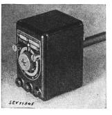
0,1 A = Description: Régulateurs de température à tube plongeur, selon figure, avec interrupteur unipolaire à coupure instantanée et dispositif de sûreté contre l'échauffement anormal des chauffe-eau à pression et à vidage. Réglage de la température par bouton rotatif. Calotte de protection en matière isolante moulée.
