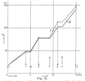
Essai d'échauffement d'une soudure sur un câble de 300 mm² I Corde. II Soudure. I Enclenchement. 2 Déclenchement. t Temps.  $\vartheta$  Température.  $\times$  o Valeurs mesurées au moment de déclenchement
