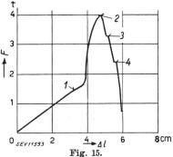
Essai de traction sur un câble en aluminium pur de 300 mm² soudé par le procédé «Alutherm»
