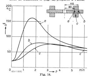
Variation de la température pendant la soudure «Alutherm» d'un câble en aluminium pur de 300 mm²  $\vartheta$  température, t temps.
