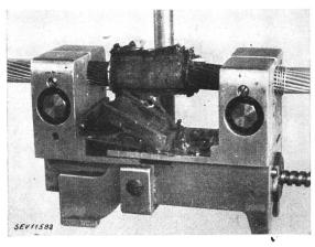
Fig. 6. Soudure terminée, scorie enlevée partiellement
