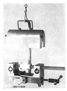
Fig. 5. Dispositif de refoulement pour la soudure «Alutherm» prêt à l'emploi
