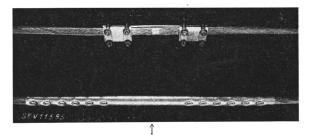
Fig. 17 Possibilités de renforcement mécanique de la soudure En haut: Renforcement par demi-tube  $En\ bas$ : Renforcement par douille de connexion à encoches
