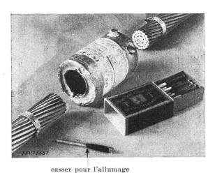
Fig. 4. Cartouche pour 300 mm² avec câble et allumette Bengale
