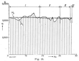
Mesures individuelles au moyen du pont de Thomson des différents fils après soudure d'une corde en aluminium de 300 mm²
