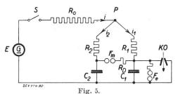
Schema der wiederholten linearen Zeitablenkung mit Entladefunkenstrecke  $F_\circ$  und Mitnehmerfunkenstrecke  $F_\mathsf{m}$  als Schaltorganen
