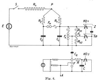
Schema für die einmalige lineare Zeitablenkung mit Sperrzweig  $R_b$   $F_b$  und Kopplung mit exponentiellem Kreis RC als Auslösesperre oder für gleichzeitige rasche exponentielle Ablenkung, mit Anstosspunkt A
