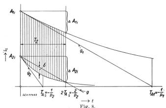
Ladestrom  $i_1$  des Zeitkondensators (schraffiert) während Laufzeit über die Zeitaxe  $T^2$  unter Ausnützung des Zeitintervalls  $T_z = -\frac{2}{}$
