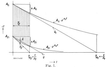
Ladestrom  $i_1$  des Zeitkondensators (schraffiert) während Laufzeit über die Zeitaxe  $T_z$ , unter Ausnützung des Zeitintervalls  $T_z = -\frac{1}{2\pi}$
