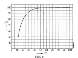
Prozentualer Anteil einer Wärmepumpe an der jährlich von der Heizanlage erzeugten Wärmemenge
