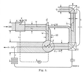
Wärmepumpe mit Dampfturbinenantrieb in einem Fernheizwerk
