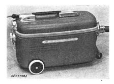
Description: Grand aspirateur de poussière, selon figure, comprenant un ventilateur à force centrifuge à deux étages, entraîné par un moteur série monophasé. Le fer du moteur est isolé du bâti. Cet appareil est muni d'un tuyau, de tubes de guidage, de diverses embouchures et d'un vibrofiltre; il peut être utilisé pour aspirer ou souffler.
