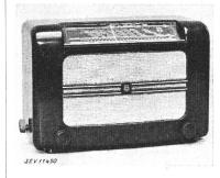
Description: Appareil radiophonie pour trois gammes d'ondes, selon figure et schéma.
