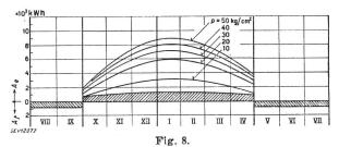
Theoretische Möglichkeiten der Erzeugung elektrischer Energie im Gegendruckbetrieb im Krankenhaus X
