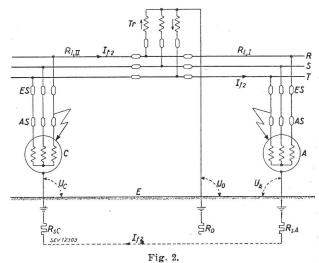
Zweipoliger Erdschluss in einem 500-V-Drehstromnetz mit Schutzerdung
