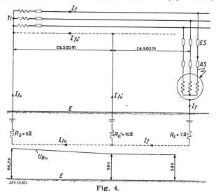
380/220-V-Drehstromnetz mit Schutzerdung und Apparatennullung
