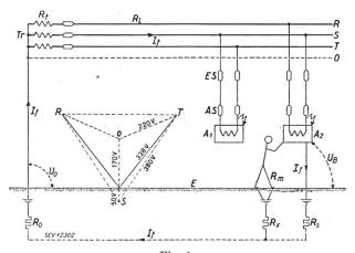
Fig. 1. Einpoliger Erdschluss in einem 380/220-V-Drehstromnetz mit Schutzerdung
