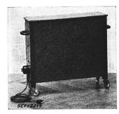
Description: Radiateur électrique, selon fig., comprenant deux résistances de chauffe bobinées sur des pièces en matière céramique et montées dans un bâti en éternite. Un interrupteur fixé au radiateur permet de faire fonctionner celui-ci à pleine ou demi charge. Raccordement au réseau par un cordon torsadé à deux conducteurs, muni d'une fiche.
