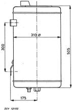
Description: Chauffe-eau à accumulation pour montage mural, selon croquis. Deux corps de chauffe et un régulateur de température avec dispositif de sûreté sont introduits par en haut.
