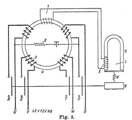
Schema eines vierpoligen Differentialschutzschalters mit eingebauter Prüfeinrichtung
