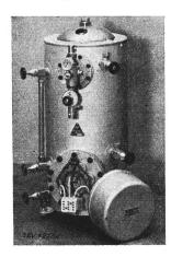
Description: Chauffe-eau à accumulation, selon fig., pour grandes installations de percolateurs. Enclenchement au moyen d'un contacteur commandé par un régulateur de pression. Le réservoir est maintenu, en service, sous une pression d'environ 0,5 kg/cm<sup>2</sup>; il est ainsi possible de soutirer de l'eau en ébullition ou de la vapeur. Le chauffe-eau est prévu pour le montage dans une armoire comprenant les accessoires nécessaires à la préparation de café etc.
