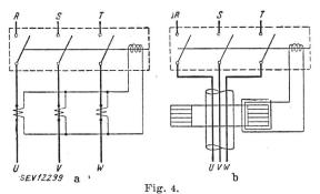
Die Differentialschutzschaltung in Verbindung mit Stromwandlern
