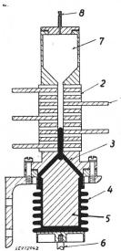
Je grösser die Ausgangsleistung des Reglers ist, desto schwieriger ist die Einhaltung dieser Bedingungen. Durch die Verwendung des Quecksilbers, das bekanntlich bereits in Schaltern erfolgreich angewandt worden ist, konnte ein leistungsfähiger auch empfindlicher Widerstandsregler, welcher die genannten Bedingungen restlos erfüllt, gebaut werden.
