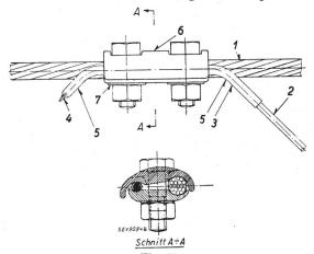
Fig. 29. Dérivation en cuivre partant d'un conducteur en aluminium
