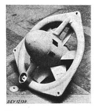
Description: Ventilateur, selon figure, entraîné par un moteur monophasé, ouvert, à induit en court-circuit, à auto-démarrage.
