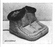
Description: Chancelières en étoffe avec élément de chauffe. App.-No. 1 selon figure, app.-No. 2 sans fermeture éclair, ouvert à l'arrière. L'élément de chauffe se compose d'un cordon de chauffe qui est cousu entre deux pièces d'étoffe. Le fil de résistance émaillé est enroulé sur une mèche d'amiante et guipé d'amiante. Raccordement au réseau au
