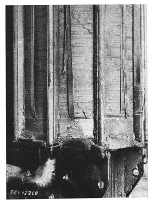
Fig. 10. Verschlammte Transformatorwicklung
