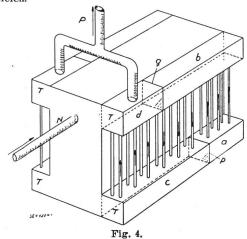
Prinzip der Kühlung bei berippten Rohren und horizontaler Luftanblasung, plus künstliche Oelzirkulation.
