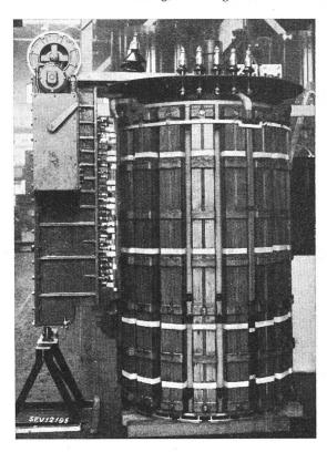
Fig. 16. Aktiver Teil eines grossen Lokomotivtransformators für 2700 kVA, 16<sup>2</sup>/<sub>3</sub> Hz mit angebautem, oberspannungsseitigem Stufenschalter
