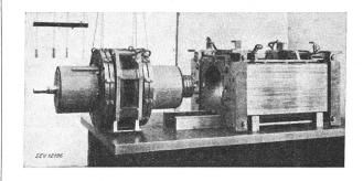
Fig. 17. Teile eines Triebwagentransformators mit radialgeblechtem Drehkern und stufenloser Stromabnahme auf den blanken Sekundärwindungen
