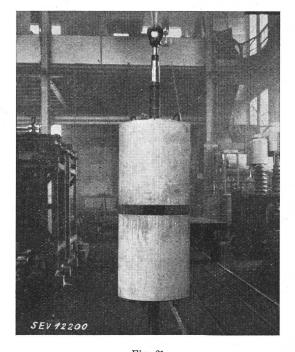
Fig. 21. Verstellbare Säulenstummel mit radialer Blechung auf drehbarer Gewindespindel für eine Drosselspule mit stufenloser Regulierung
