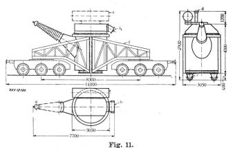
Radialgeblechter Einphasentrausformator für eine dreiphasige 240-MVA-Gruppe mit 400 kV Oberspannung
