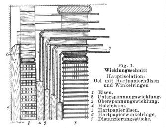
Wicklungen sind in regelmässigen Abständen Hartpapierhülsen angeordnet. An den Wicklungsenden sind zwischen die Hülsen Winkelringe aus Hartpapier eingeschoben, deren Flanschen als Querisolation gegen die Joche dienen. Das Ganze stellt eine Oelisolation mit Barrieren dar. Hülsen und Winkelringe sind mit Leisten aus imprägniertem Buchenholz, teilweise auch Preßspan oder Transformerboard, distanziert.
