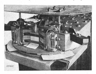
Fig. 18. Jochpressung bei einem zweischenkligen Eisenkern mit radialgeblechten Säulen und quergeblechten Jochen
