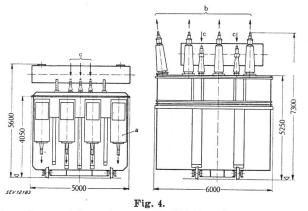
Dimensionsvergleich eines 47 500-kVA-Transformators neuer Isolationsart (links) mit 150-kV-Kabelanschlüssen, mit einem 26 000-kVA-Transformator aus dem Jahre 1928 (rechts) mit 150-kV-Freiluftdurchführungen
