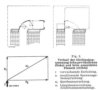
Fig. 3 zeigt den Unterschied der Gleitfunkenspannung an der Spitze einer vorwachsenden Entladung bei einem Isolationsflansch ohne Spreizung und beim Spreizflansch. Am Rücken des Flansches links wird die vorwachsende Entladung durch eine
