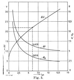
Spannungsabfall und Durchgangswiderstand eines Selengleichrichter-Elementsatzes bei Einphasen-Grätzschaltung Typ 63/8 BIKfb 8.1.2 (112 Ø). Ladung von 30 Bleizellen: 63...80 V, 6...3,4 A.  $i_{0}$ b Ladestrom.  $\Delta U$  Spannungsabfall des Elementsatzes,  $R_d$  Durchgangswiderstand des Elementsatzes. R'Widerstand des gesamten Stromkreises inkl. Ladewiderstand.
