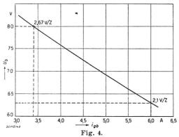
Lade-Charakteristik eines Selen-Trockengleichrichters bei Einphasen-Grätzschaltung 30 Bleizellen: 63...80 V, 6...3,4 A.
