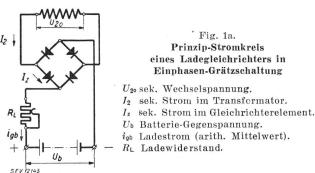
dient einerseits zur Fixierung eines maximal zulässigen Formfaktors und anderseits zur Begrenzung des Ueberstromes bei Netzüberspannung. Die grundsätzliche Schaltung eines einfachen Ladegleichrichters der gebräuchlichsten Ausführung zeigt Fig. 1a.
