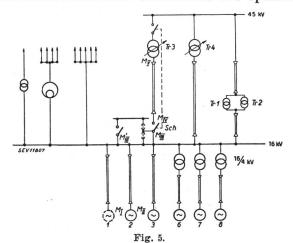
Prinzipschema der Versuche in der Drehstromlage 16 kV, 50 Hz Tr 3 Versuchstransformator. Sch Versuchsschalter.  $M_1 \cdots M_V$  Meßstellen des Kathodenstrahl-Oszillographen.
