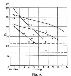
Häufigkeit verschieden hoher Abschalt-Ueberspannungen über den öffnenden Schalterpol, bei Drehstrom 16,5 kV, 50 Hz n Anzahl Schaltungen, die Ueberspannungen gleich oder grösser als Ordinatenwert ergaben. Kurvenbezeichnung wie Fig. 7.
