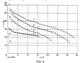
Häufigkeit verschieden hoher Abschalt-Ueberspannungen am Drehstrom-Transformator bei 16,5 kV Betriebsspannung, 50 Hz n Anzahl Ueberspannungen aller drei gemessenen Phasen, die den Ordinatenwert erreichten oder überstiegen. Kurvenbezeichnung wie Fig. 7.
