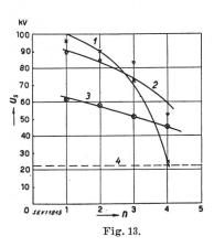
Fig. 13. Häufigkeit verschieden hoher Abschalt-Ueberspannungen am Transfor-mator im Einphasennetz 16 kV, 16% Hz
