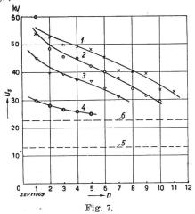
Häufigkeit verschieden hoher Abschalt-Ueberspannungen am Drehstrom-Transformator bei 16,5 kV Betriebsspannung, 50 Hz
