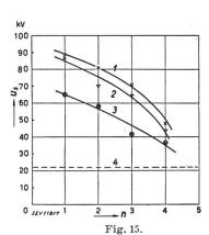
Fig. 15. Häufigkeit verschieden hoher Abschalt-Ueberspannungen zwischen den Kontakten eines Schalterpols, bei der Transformator-Abschaltung im Einpha-sennetz 16 kV, 16% Hz
