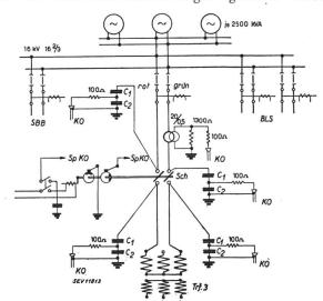
Fig. 11. Prinzipschema der Versuche in der Einphasenstrom-Bahnanlage  $16~\mathrm{kV},~16\%$  Hz
