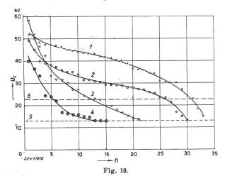
Häufigkeit verschieden hoher Abschalt-Ueberspannungen über den öffnenden Schalterpol, bei Drehstrom 16,5 kV, 50 Hz n Anzahl Ueberspannungen aller drei gemessenen Phasen, die den Ordinatenwert erreichten oder überstiegen. Kurvenbezeichnung wie Fig. 7.
