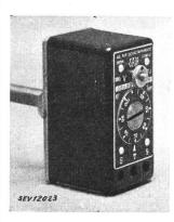
Description: Régulateurs de température à tube plongeur, selon figure, avec commutateur unipolaire actionné par les variations de longueur d'une tige métallique. Le commutateur, à coupure instantanée, est muni de contacts en argent. Les pièces de contact sont fixées sur une plaque en matière céramique. La calotte de protection, en matière isolante moulée, peut être plombée.
