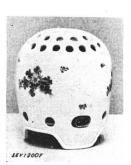
Description: Radiateur avec bâti en matière céramique, selon figure. Le corps de chauffe se compose de fil résistant enroulé en boudin, logé dans les rainures de deux pièces cylindriques en matière céramique, placées perpendiculairement l'une à côté de l'autre. Le raccordement du cordon d'alimentation s'effectue au moyen d'une fiche d'appareil.
