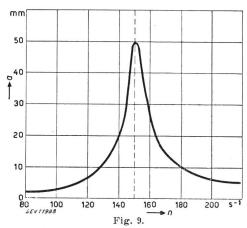
Ablenkung a in mm in Funktion der Rotordrehzahl n pro Sekunde.
