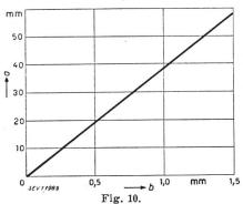
Ablenkung a in mm in Funktion der Bohrtiefe b in mm, Bohrer Ø 2 mm, Winkel 90°.
