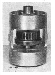
Fig. 5. Kreisel, im Rahmen des Prüfgerätes eingespannt
