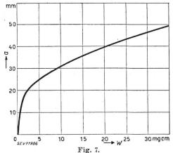
Ablenkung a in mm in Funktion der Unwucht (W) in mgcm
