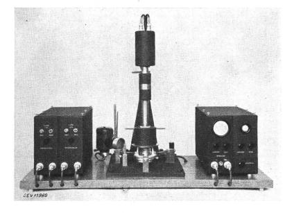
Fig. 1. Auswuchtgerät für Kreisel
