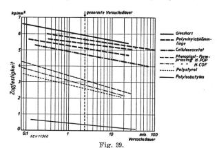
Zugfestigkeit verschiedener Kunststoffe in Abhängigkeit von der Versuchsdauer (Festigkeit-Zeitlinien, Prüftemperatur 20° C)
