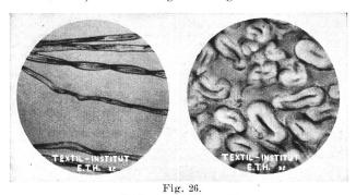
Gefüge von Baumwolle Links: Längsaufnahme 150fach. Rechts: Querschnitt 400fach. Für die Wiedergabe 1:2 verkleinert.
