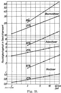
Feuchtigkeitsaufnahme von Asbest-, Baumwoll- und Glasfasern in Abhängigkeit von der Zeit
