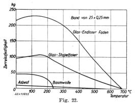
Zerreissfestigkeit von Bändern aus Asbest, Baumwolle und Glas in Abhängigkeit von der Temperatur
