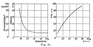
Zusammenhang zwischen der Faserdicke und der Zugfestigkeit von Glasfasern (links); Zusammenhang zwischen der Verknotbarkeit und der Dicke von Glasfasern (rechts)
