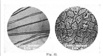
Gefüge von Zellwolle aus Viskose Links: Längsaufnahme, 160-fach. Rechts Querschnitt, 400 fach. Für die Wiedergabe 1:2 verkleinert.
