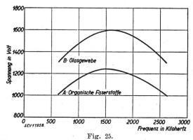
Abhängigkeit der Radiobeanspruchung bei Geweben aus organischen Faserstoffen und bei Glasgeweben
