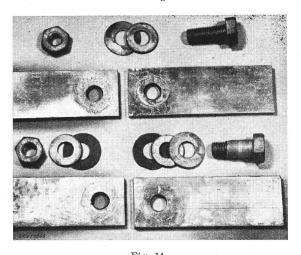
Fig. 14. Korrosionen auf Schienenverschraubungen Aluminium-Kupfer nach 70tägiger Behandlung im Salzsprühnebel
