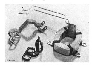
Fig. 17. Stromspulen aus Aluminium für Zähler Links: Spule für 100 A mit Punktschweissung in halbfertigem Zustand.
