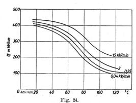
Abhängigkeit der Durchschlagspannung von Glasgeweben von der Temperatur und der Spannungssteigerung
