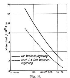
Abhängigkeit des Isolationswiderstandes von Kautschuk-Alkaliregenerat vor und nach der Lagerung in Wasser
