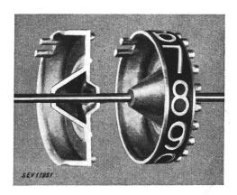
Fig. 16. Zahlenrolle eines Zählwerkes aus Aluminiumblech (Landis & Gyr) Siehe Bull. SEV 1942, Nr. 25, S. 750.
