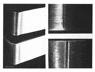
Fig. 10. Biegeproben von Aluminium Obere Probe vor dem Biegen zur Kennzeichnung der Biegestelle mit Bleistiftstrich versehen, untere Probe Biegestelle mit Stahlnadel; Rissbildung nach dem Biegen
