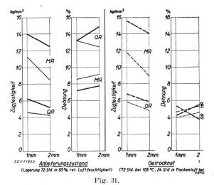
Mechanische Eigenschaften von Transformerboard  $Links\colon$  im Anlieferungszustand nach 72stündiger Lagerung in 65 % rel. Luftfeuchtigkeit. Rechts: in getrocknetem Zustand, 72 Stunden bei 105° C trocknet, 24 Stunden in Trockenluft bei 20° C gelagert.
