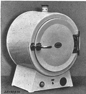
*Description:* Étuve selon figure; dimensions intérieures: diamètre 360 mm, profondeur 270 mm. Les parois intérieures sont en tôle d'aluminium. L'étuve possède: 3 rayons, un régulateur de température réglable de 40 à 240° C, un thermomètre, un interrupteur unipolaire et une petite lampe.
