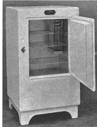
**Description:** Armoire frigorifique de ménage, selon figure. Le froid est produit par un dispositif à absorption à fonctionnement continu monté à l'arrière de l'armoire; refroidissement à air. La température intérieure est réglée par un thermostat réglable. L'armoire frigorifique possède deux tiroirs à glace. Raccordement au réseau par un cordon à gaine de caoutchouc à 3 conducteurs muni d'une fiche.
