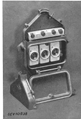
*Description:* Coffret d'abonné pour réseau triphasé, selon figure, avec trous de plombage et sectionneur du neutre non isolé du coffret, muni de socles de coupe-circuit pour 100 A selon norme SNV 24475. Coffret en fonte muni d'une borne de terre.
