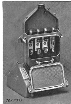
*Description:* Coffret d'abonné pour réseau triphasé, selon figure, avec trous de plombage et sectionneur du neutre isolé du coffret, muni de socles pour coupe-circuit basse tension à haut pouvoir de coupure. Coffret en fonte muni d'une borne de terre.
