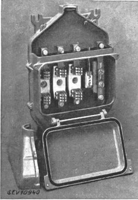
**Description:** Coffret d'abonné pour réseau triphasé, selon figure, avec trous de plombage et sectionneur du neutre isolé du coffret, comprenant 3 socles pour coupe-circuit basse tension à haut pouvoir de coupure et un socle pour fusibles à broches. Coffret en fonte muni d'une borne de terre.
