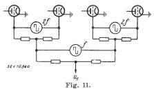
Der Vierfachverteiler mit pyramidenartig übereinandergeordneten Generatoren
