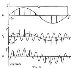
Falsche Ausdeutung einer Uebertragung bei niedriger Frequenz der Sendefunktion (a)
