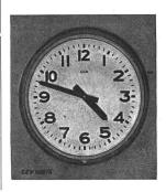
Description: Horloge murale selon figure, avec boîtier métallique ayant 300 mm de diamètre. Mouvement avec balancier, échappement et réserve de marche. Remontage par un moteur Ferraris enclenché en permanence. Le raccordement du cordon d'alimentation s'effectue au moyen d'un serrefils fixé à un conducteur de courte longueur.
