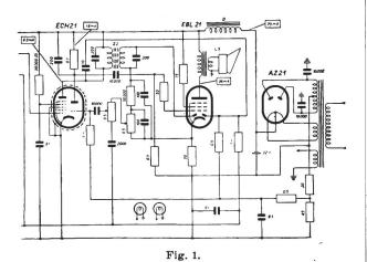
NF- und Speiseteil eines Radio-Empfängers mit neuartiger Gegenkopplung
