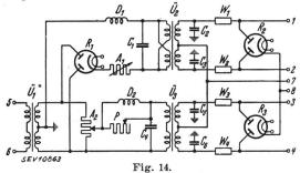
Schaltschema des Generators für die Steuerspannung eines Vielfachverteilers
