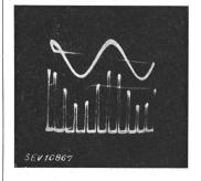
Fig. 18. Oszillogramm eines Verteilerkanals mit sehr tiefer Modulierfrequenz
