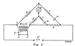
Pont double de Thomson généralisé pour la mesure de l'impédance de court-circuit d'un transformateur, lorsque cette dernière est de faible valeur
