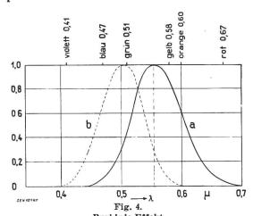
Purkinje-Effekt Relative spektrale Hellempfindlichkeit a für hell adaptiertes Auge, Zäpfchensehen, Leuchtdichte > 3 FK/m²
