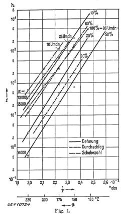
Lebensdauerkurven von Lackdraht A für verschiedene Grade der Zerstörung
