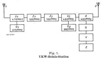
1 Empfangs-Antenne. 2 Sende-Antenne.  $U_1$  erster Frequenzumsetzer.  $O_1$  erster Ueberlagerungsoszillator.  $Z_1$   $Z_2$  Zwischenfrequenz-Verstärker.  $U_2$  zweiter Frequenzumsetzer.  $O_2$  zweiter Ueberlagerungsoszillator. A Ausgangs-Stufe. G Gleichrichter. V Videoverstärker. E Kontroll-Empfänger.
