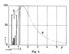
Relative spektrale Intensitätsverteilung a kontinuierliches Spektrum, das ungefähr einer Glühlampe entspricht. b Linienspektrum der neuen Verdunkelungslampe. Das Maximum der Intensität wurde für beide Strahler willkürlich mit 100 bezeichnet.
