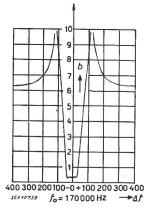
Fig. 5. Durchlasskurve eines Kristallfilters
