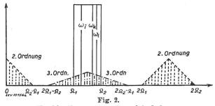
Kombinationsspektren 2. und 3. Ordnung eines zwischen den Kreisfrequenzen  $\Omega_1$  und  $\Omega_2$  eingeschlossenen kontinuierlichen Frequenzbandes.
