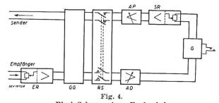
Block-Schema einer Funkgabel ER Empfangsregler. SR Senderegler. RS Rückkopplungssperre. AP Amplitudenpresser. AD Amplitudendehner. G Gabel. GG Geheimhaltungsgerät.
