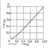
Fig. 6. Eichkurve des Röhrenvoltmeters
