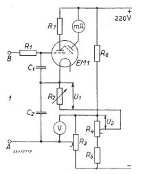
Fig. 3. Schaltung zur Untersuchung der Wirkungsweise des verbesserten Abstimm-
