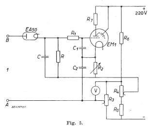
Schaltung des Abstimmanzeigers als Röhrenvoltmeter  $C=0.01~\mu{\rm F}$  (Glimmerkondensator);  $R=10~{\rm M}\Omega$  ; übrige Grössen wie in Fig. 3.
