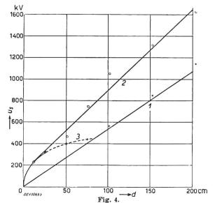
50%-Stossfestigkeit von Kugel-Platte- und Spitze-Platte-Funkenstrecken beim Stoss 1,5/40  $\mu s$  in Funktion der Schlagweite  $u_i$  Scheitelwerte, in kV d Schlagweite, in cm
