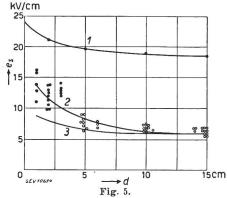
Mittlere spez. Festigkeit (e,) von Luft bei Wechselspannung von Industriefrequenz in Funktion der Schlagweite (d)
