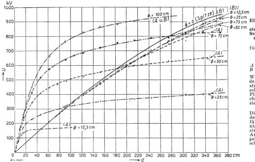
Fig. 3. Elektrische Festigkeit von Kugel-Platte-Funken-strecken in Funktion der Schlagweite bei Wechsel-spannung von Industrie-frequenz spannung von In frequenz
