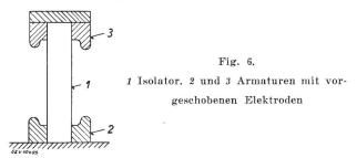
Die Festigkeit zwischen zwei parallelen Drähten ist ebenfalls erheblich höher als zwischen Spitzen. Bei deren Messung müssen die Drähte abgebogen werden, damit die Enden nicht als Spitzen wirken. Die Drähte könnten auch in Ringe geschlossen werden, so dass sie keine Enden besitzen. Dieses Vorgehen wäre konstruktiv verwendbar, wenn die Armaturen so ausgebildet würden, wie Fig. 6 andeutet.
