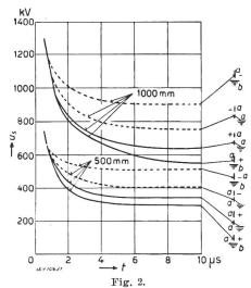
Stossfestigkeit der Stab-Stab- und Stab-Platte-Funkenstrecke in Funktion der Beanspruchungsdauer für zwei Schlagweiten
