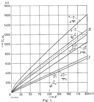
Elektrische Durchschlagsfestigkeit von Stab-Stab. und Stab-Platte-Funkenstrecken in Luft
