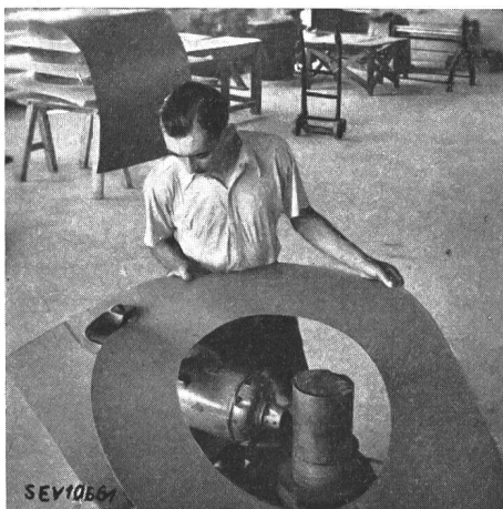
Fig. 1. Ausschneiden von Preßspan mit Blechschere
