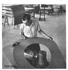
Fig. 1. Ausschneiden von Preßspan mit Blechschere
