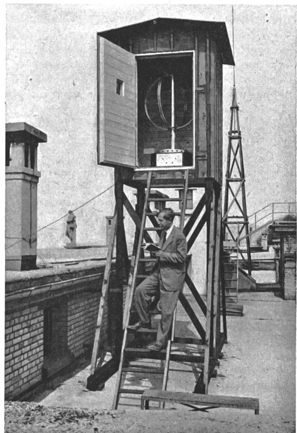
Fig. 3. Die Antennen des Goniographen auf dem Dach der Meteorologischen Zentralanstalt in Zürich
