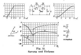
übertragen werden muss, wäre unnötig scharf formuliert. Es genügt, eine mit einer endlichen Flankensteilheit ansteigende Kante den Berechnungen zu Grunde zu legen, wie dies in Fig. 12 bis 14 zur Darstellung gebracht wurde. Die Anstiegsbreite der Kante richtet sich nach den Schärfeanforderungen, die man an das Fernsehbild stellt, und sie muss für ein einwandfreies Bild logischerweise gleich dem Auflösungsvermögen des Auges gesetzt werden.
