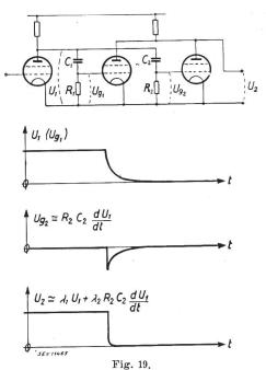
Korrektur der durch das Nachleuchten hervorgerufenen Signalverzerrung beim Leuchtschirmabtaster
