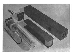
Fig. 6. Elektronenvervielfacher des Institutes für technische Physik der ETH, Zürich
