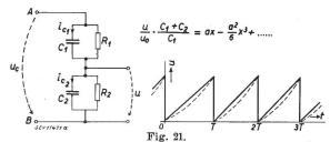
Korrektur der Kippspannung nach Fig. 20
