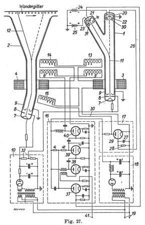
AFIF-Fernsehgrossprojektor Schaltschema des Regulierrohres
