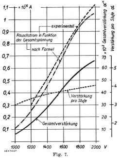
Verstärkung und Rauschstrom des Elektronenvervielfachers nach Fig. 6 als Funktion der gesamten an den Vervielfacher und die Photokathode gelegten Spannung
