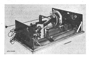
Fig. 30. Montiertes Regulierrohr mit den Ablenk- und Fokussierspulen
