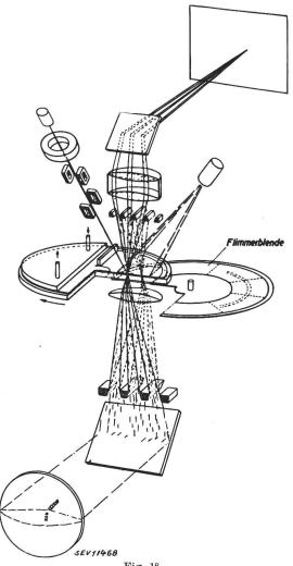
Fig. 18. AFIF-Grossprojektor mit Flimmerblende
