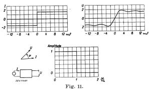
Einheitssprung und idealisierter Tiefpass
