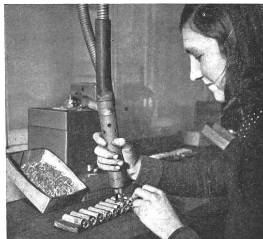
Fig. 25. Schweißen mit Kohlestift von Taschenlampenbatterien
