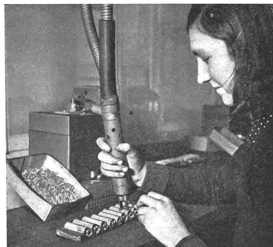
Fig. 25. Schweißen mit Kohlestift von Taschenlampenbatterien
