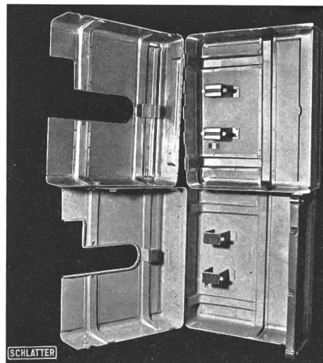
Fig. 19. Nähmaschinenkasten mit ca. 250 Punktschweissungen
