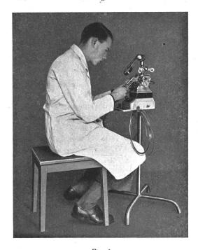
Fig. 1. Feindrahtschweissmaschine für Drahtdicken von 0,3...2 mm ∅
