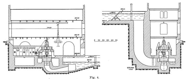
Kraftwerk Hochfelden nach dem Umbau im Jahre 1942 Eine Kaplanturbine 540 kW mit zugehörigem Generator 620 kVA, 380/220 V, 50 Hz
