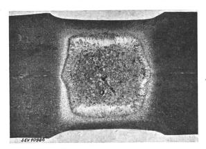
Fig. 9. Schnitt durch zu grossen Schweisspunkt
