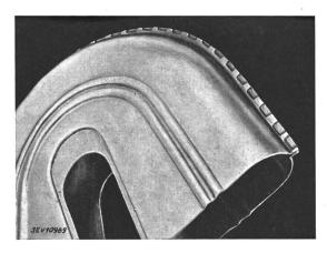
Fig. 12. Beispiel einer Punktschweissung, die der Nahtschweissung nahekommt
