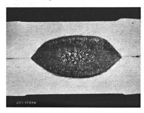
Fig. 7. Schnitt durch gesunden Schweisspunkt
