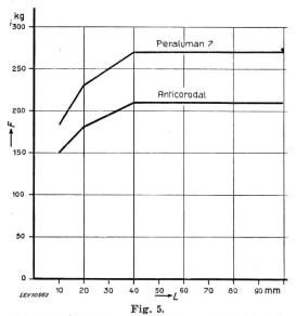
Scherkraft F in kg pro Schweisspunkt in Funktion des Schweisspunktabstandes L
