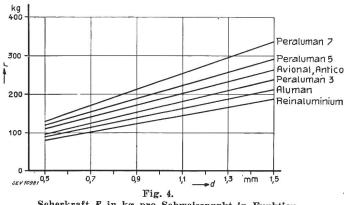
Scherkraft F in kg pro Schweisspunkt in Funktion der Blechdicke d in mm
