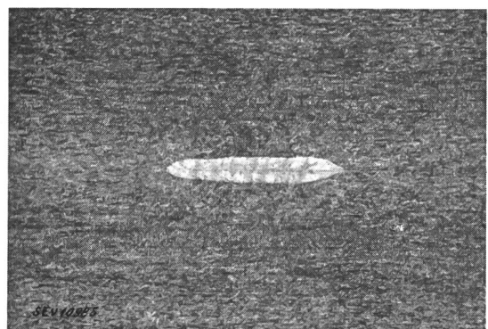
Fig. 8. Schnitt durch zu kleinen Schweisspunkt
