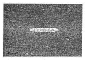
Fig. 8. Schnitt durch zu kleinen Schweisspunkt
