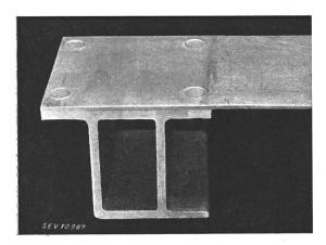
Fig. 10. Schweissung von Al-Profil auf Blech
