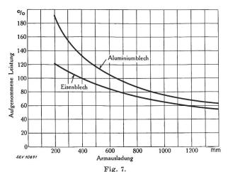
Aufgenommene Leistung in Funktion der Armausladung bei konstantem Armabstand und konstanter Leerlauf-Sekundärspannung
