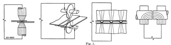
Die 4 Hauptschweissarten: Punkt-, Rollennaht-, Relief- und Stumpf- oder Abbrennschweissung Die 4 Figuren zeigen den Weg des Schweißstromes in den Elektroden und im Schweissgut.
