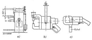
Fig. 15. Vergleich der Anschlussleistung der 3 Hauptarten von Punktschweissmaschinen
