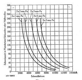
Fig. 9. Notwendige Schweisszeit in Funktion des Schweißstromes zum Punktschweissen von Eisen Für Eisen kann die Schweisszeit und der Schweißstrom in weiten Grenzen gewählt werden.
