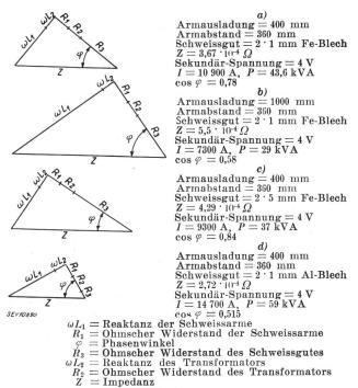
Fig. 6. Impedanzdiagramme für eine Punktschweissmaschine bei veränderlicher Armausladung, Blechdicke und verschiedener Materialart
