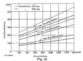
Anschlussleistung von Punktschweissmaschinen beim Verschweissen von Al-Blech
