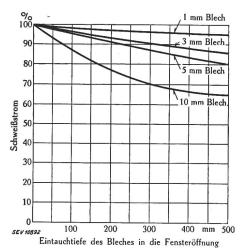
Fig. 8. Einfluss der Eintauchtiefe des Bleches in die Fensteröffnung der Schweissarme auf den Schweißstrom Durch das Schweissgut in der Fensteröffnung wird der Schweißstrom verkleinert.
