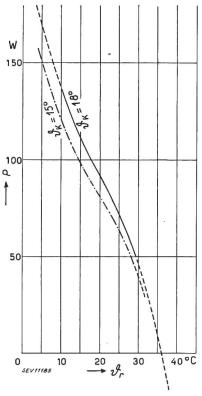
Fig. 1. Déperdition de chaleur P d'un individu normalement vêtu. en W par rayonnement, conduction et convection, en fonction de la température ambiante  $\vartheta_r$ , pour une occupation peu active, en position assise, dans un air calme: avec un vêtement prévu normalement pour  $18^{\circ}$  C ( $\vartheta_{\rm K} = 18^{\circ}$ C); avec un vêtement prévu normalement
