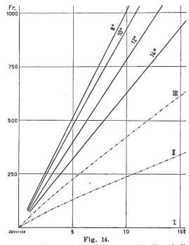
Diagramme de l'économie réalisée avec un chauffage individuel par contact, en fonction de la quantité de coke pour 3 prix de coke et des températures ambiantes de 8, 10, 12 14° C.
