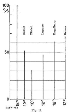
Quantité de chaleur nécessaire pour le chauffage du local à 12° C (pour Zurich, à 10° C également), en % de la quantité de chaleur exigée pour un chauffage normal (à 18° C), pour quatre localités de Suisse situées à des altitudes différentes, d'après la moyenne des températures de 1869 à 1929.
