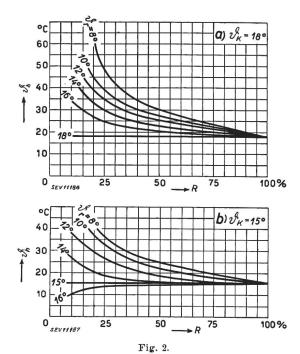
Température d'une enveloppe  $\vartheta_h$  en fonction de la grandeur relative de la surface enveloppante R,
