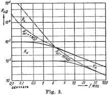
Wirkwiderstände eines  $1\text{-M}\,\Omega$ - und eines  $100\text{-k}\,\Omega$ -Widerstandes (Index L deutet auf ungeerdeten, Index K auf geerdeten Widerstand)
