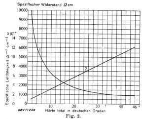
Spezifischer Widerstand und Leitfähigkeit von Rohwasser bei 20°C in Abhängigkeit der Gesamthärte (Alpen- und Juragebiet) 1 Spezifischer Widerstand. 2 Spezifische Leitfähigkeit.
