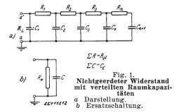
nur eine geringe Zahl von Elementen gezeichnet) und nach der Impedanz  $\Re_{\mathsf{L}}$  (resp. nach  $R_{\mathsf{w}}$  und C) zwischen den Klemmen a und a' gefragt (vgl. Fig. 1b). Unter der Voraussetzung, dass  $R_{\mathsf{gL}} < \frac{1}{\omega C_{\mathsf{E}}}$  ist und dass Ableitung und Selbstinduktion vernachlässigbar klein sind, können wir mit Hilfe der Leistungsgleichungen  $\Re_{\mathsf{L}}$  berechnen; wir erhalten:
