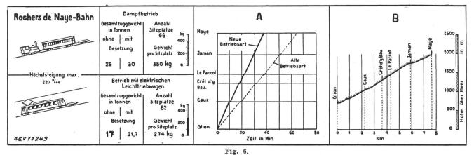
Zahnradbahn Glion-Rochers de Naye Zuggewicht, Sitzplätze und Fahrzeiten beim Dampfbetrieb und beim elektrischen Betrieb. A Graphischer Fahrplan. B Längenprofil.
