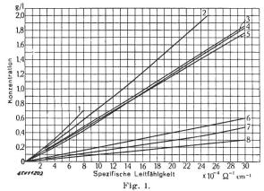
Spezifische elektrische Leitfähigkeit von Elektrolyten bei 18° C in Abhängigkeit der Konzentration (nach Landolt-Börnstein)
