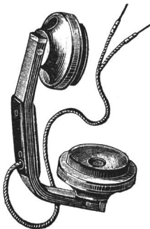
Fig. 2. Sprech-Hör-Telephon (Kuhhornform). (Aus dem Katalog von 1898.)
