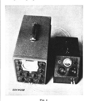
Ansicht des Kathodenstrahl-Oszillographen mit dem vereinfachten Strahlsperr-Gerät Links: Kathodenstrahl-Oszillograph. Rechts: Strahlsperr-Gerät.
