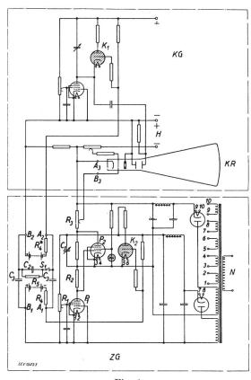
Fig. 1 Schema eines Kathodenstrahl-Oszillographen mit Zusatz-Kippgerät
