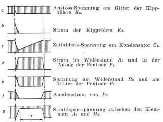
Fig. 2. Verlauf der Ströme und Spannungen bei der Strahlsperrung
