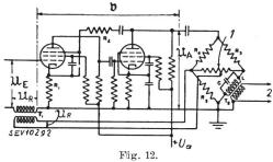
Frequenzabhängige Gegenkopplung mit Brücke v Verstärkungsfaktor. 1 Regelung der Resonanzschärfe. 2 Transformator-Ausgang.
