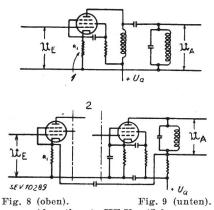
Abgestimmte HF-Verstärker 1 Gegenspannung. 2 Kondensator- oder Bandfilter-Kopplung.
