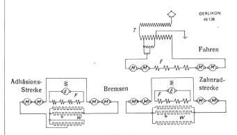
Fig. 6. Schaltschema der FO-Lokomotive.
